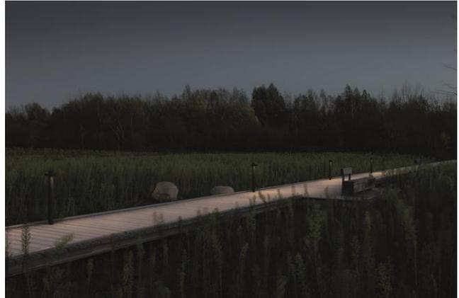
**5** Zum Vergleich: Der reduzierte blaue Lichtanteil wie hier bei der Variante Polesano Bollard NCL vermeidet Störungen im natürlichen Verhalten von Tieren und trägt zur Erhaltung der Biodiversität bei. Foto: Deltalight
