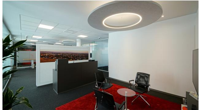
**5** Ob rund, oval, quadratisch, rechteckig oder ringförmig: Die objektspezifisch gefertigten Akustikleuchten werden zum markanten Raumbestandteil. Foto: luxwerk
